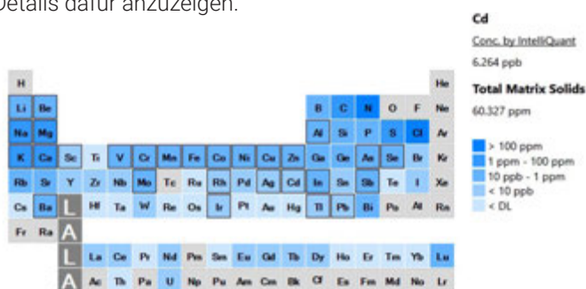
Abbildung 1. Beispiel einer IntelliQuant Heat Map mit den semiquantitativen Daten für alle messbaren Elemente in einer Probe.
